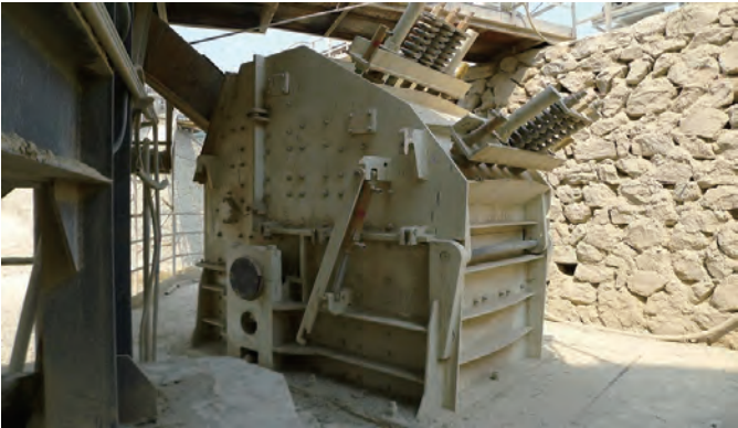
北京金隅水泥厂 Beijing Jinyu Cement Plant 反击式破碎机 Impact Crusher
